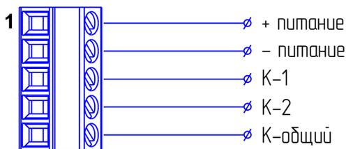
Рис. 7. СЕНС-ДКП. Схема подключения
