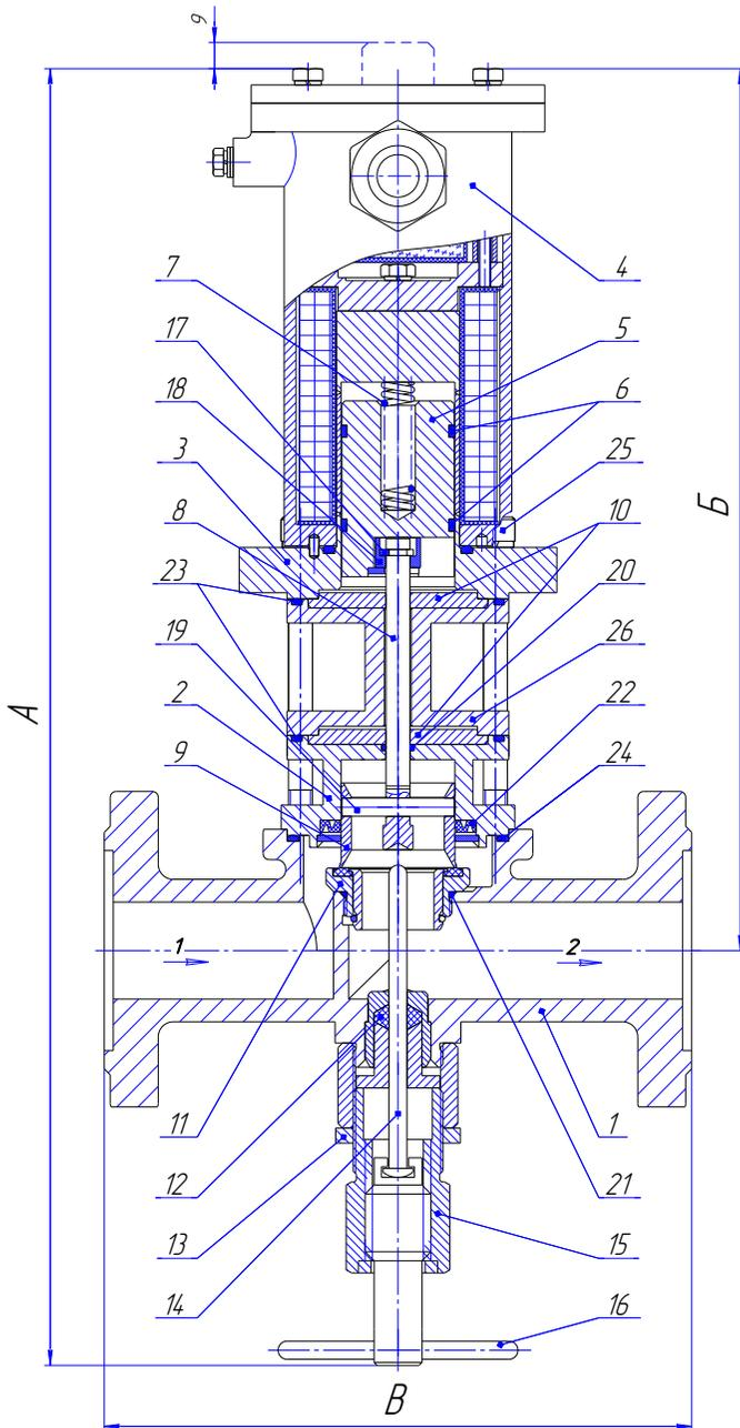
Рис. 16. Клапан **СЕНС...-М, СЕНС...-В-200С**. Общий вид.
