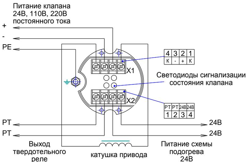
Рис. 6б Модуль-СФУ-12/24В, 110/220В постоянного тока. Схема подключения
