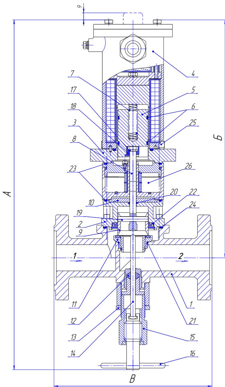
Рис. 1в. Клапан СЕНС...-В-ДКП. Общий вид.
