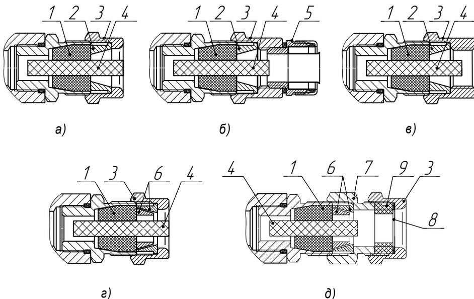
1 – кольцо уплотнительное; 2 – втулка нажимная; 3 – втулка резьбовая; 4 – заглушка; 5 – крепежный элемент; 6 – втулки УКБК; 7 – втулка УКБКг; 8 – шайба УКБКг; 9 – кольцо уплотнительное УКБКг
